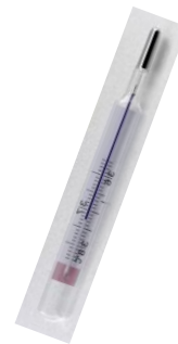
Hình 4. Nhiệt kế galinstan
